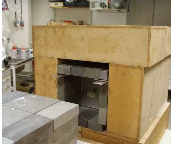
Fig. 5.4 Skärmning av neutrondetektorn. (Blytackorna framför detektorn är till för bakgrundsmätning se även avsnitt 5.2).
